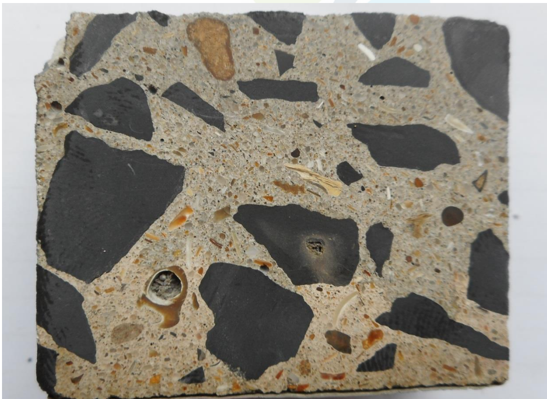
Foto 2: Blokje voor de productie van het slijpplaatje
