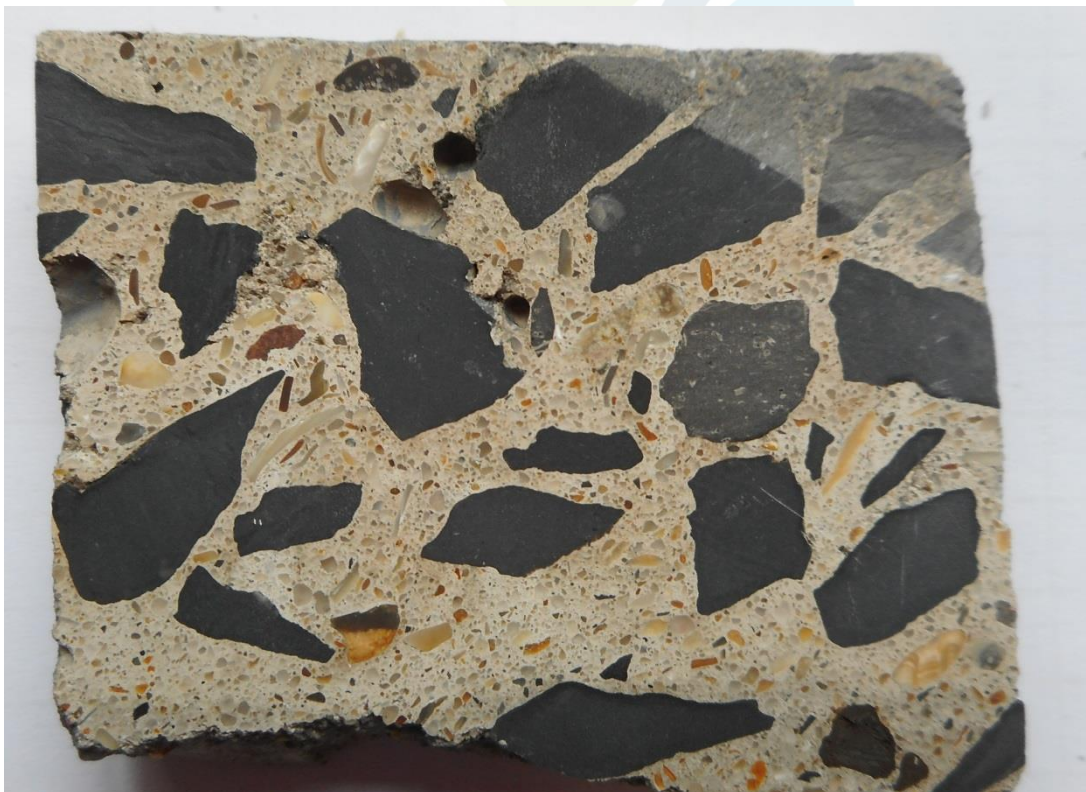
Foto 2: Blokje voor de productie van het slijpplaatje
