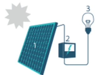
1. Zonnepaneel | 2. Omvormer | 3. Elektrische toestellen
