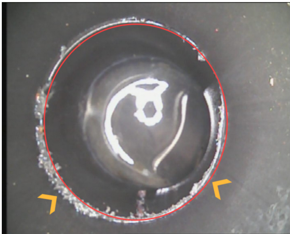
Foto 76 : de vermoedelijke plaats van de lekkage is opgespoord en aangeduid.
