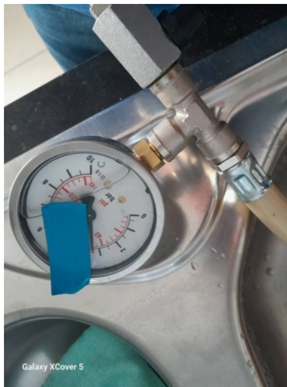
Foto 44 : Na het afsluiten van het toilet was er geen verlies meer op de installatie.
