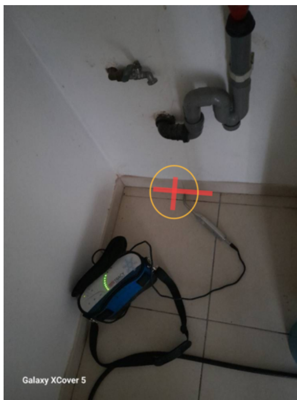
Foto 76 : de vermoedelijke plaats van de lekkage is opgespoord en aangeduid.
