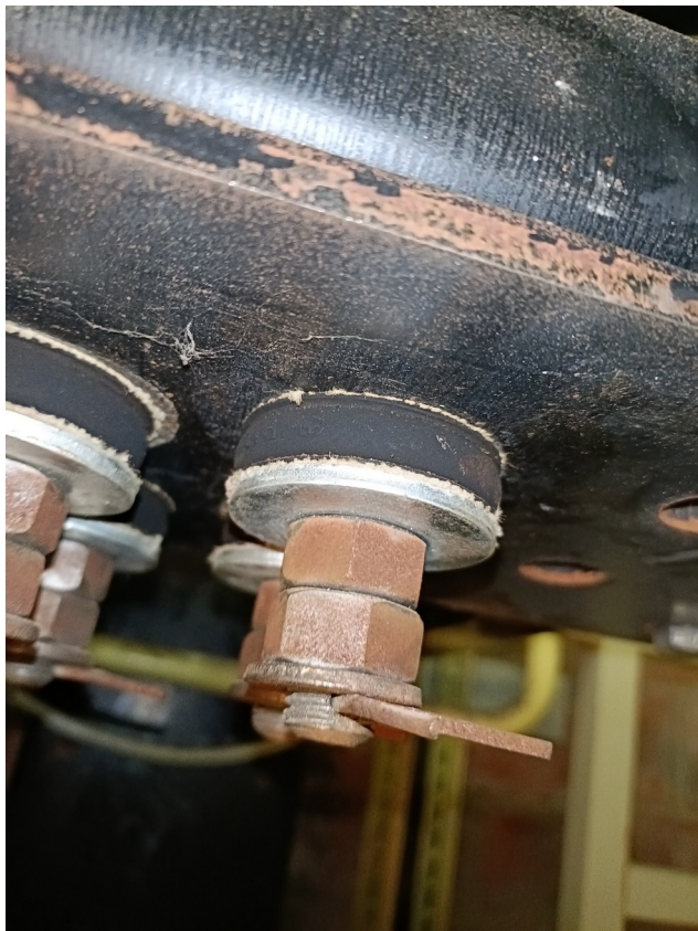
Die rubberen ringetjes zijn de enige elastische materialen in de ophanging. Dit is onvoldoende.
