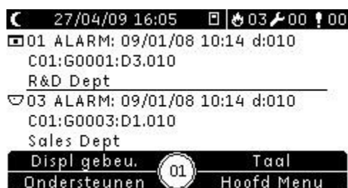
Afbeelding 4: Brandalarmaanduiding op de LCD van de centrale
